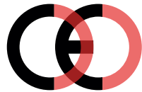
Falsche CE-Kennzeichnung (zu dicht)
